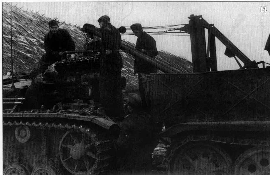
14. Замена двигателя на штурмовом орудии StuG III. 2-я танковая группа, октябрь 1941 года (фото из архива Я. Магнуского).
