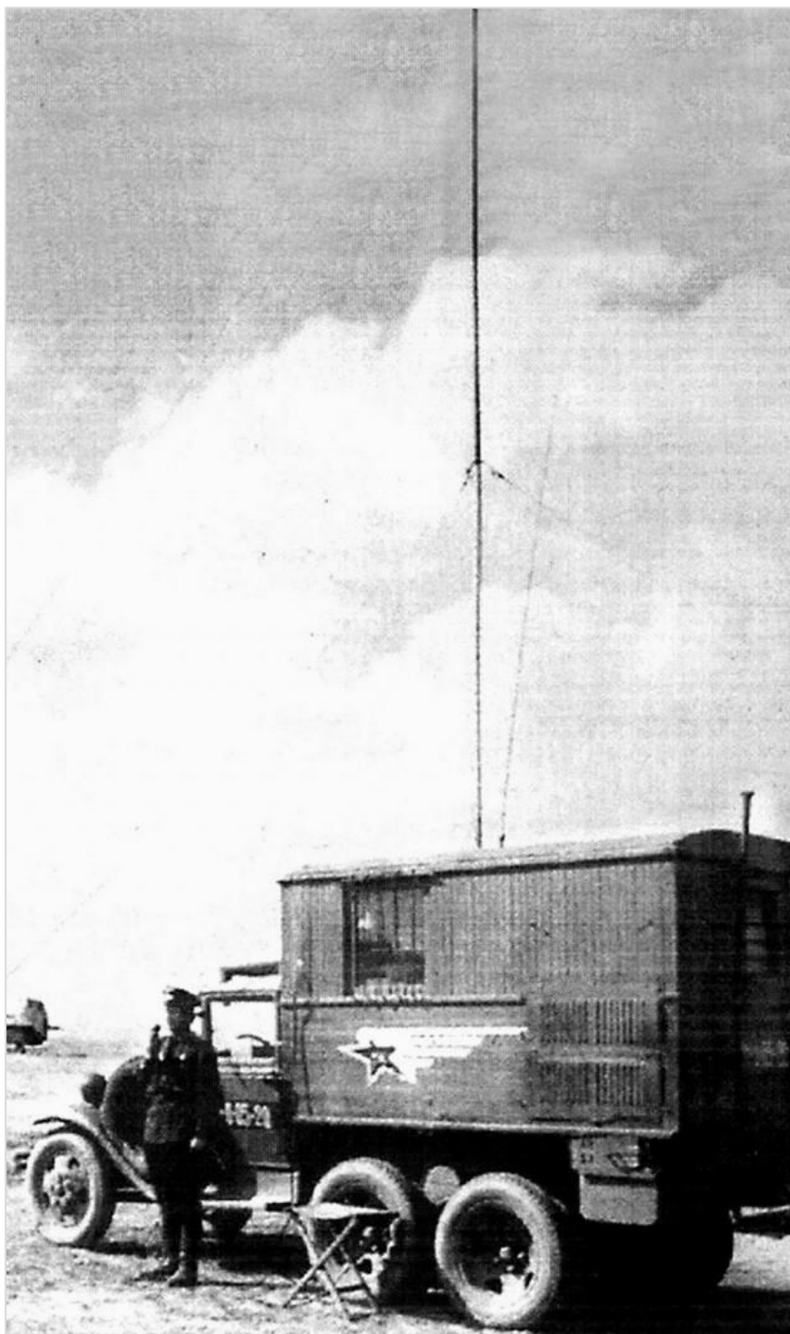
Радиостанция РСБ-Ф на базе автомобиля ГАЗ -ААА
